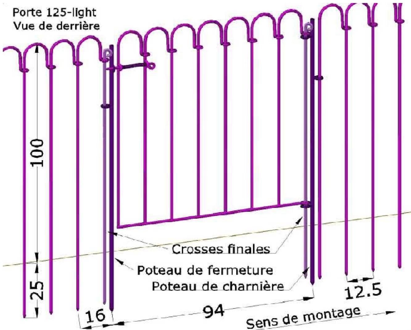
Enfoncez le deuxième poteau dans le sol, l'écart de mi-poteau à mi-poteau d'une porte standard est de 94 cm. Les 2 anneaux du poteau de charnière doivent être tournés vers le poteau de fermeture. Positionnez la porte au-dessus des 2 anneaux du poteau de charnière et insérez une crose finale à travers des anneaux de la porte et du poteau.
