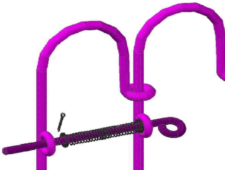
Installez le verrou à ressort au portillon. Vous voyez de gauche à droite entre les deux œillets du verrou : la goupille de sécurité, une rondelle, 2 ressorts et la deuxième rondelle.
