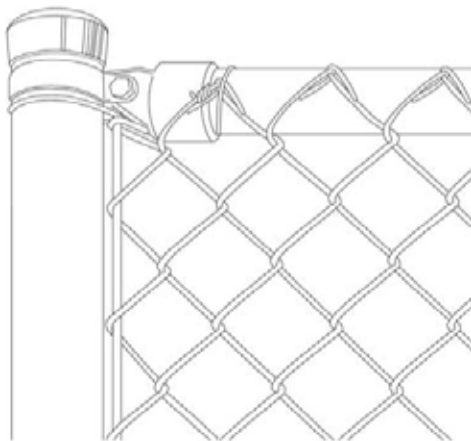
Poteau de début ou de fin + embout de lisse (= capuchon charnière Ø 42 mm, +collier = Ø du poteau d'angle -> à déterminer + boulon) + lisse tubulaire
