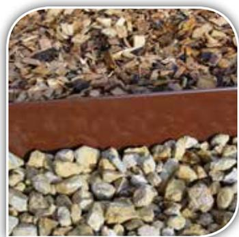
Ces Voliges® sont très simples et rapides à mettre en oeuvre : la pose s'effectue de gauche à droite en continu avec une jonction effectuée par un pieu de fixation. L'enfoncement peut se faire avec une cale intermédiaire de protection dans les sols souples. Nous préconisons de laisser la partie visible inférieure au 1/5<sup>ème</sup> de sa hauteur totale.
